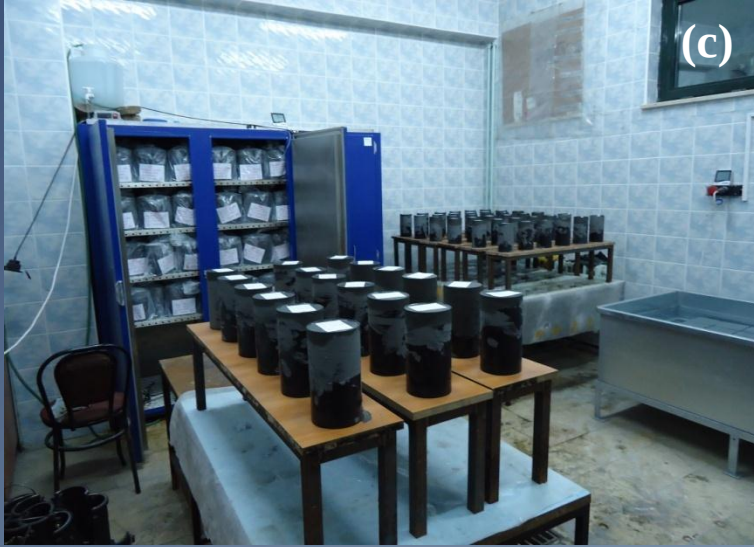
Numunelerin hazırlanması: karışım (a); sıkılama (b); kür alma (c) dayanım testi (d)
