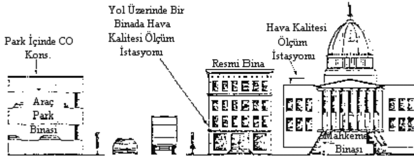
Şekil 2. Şehir İçinde Karbon Monoksit Konsantrasyonunu Ölçmek İçin Numune Alma Yeri Tespiti
