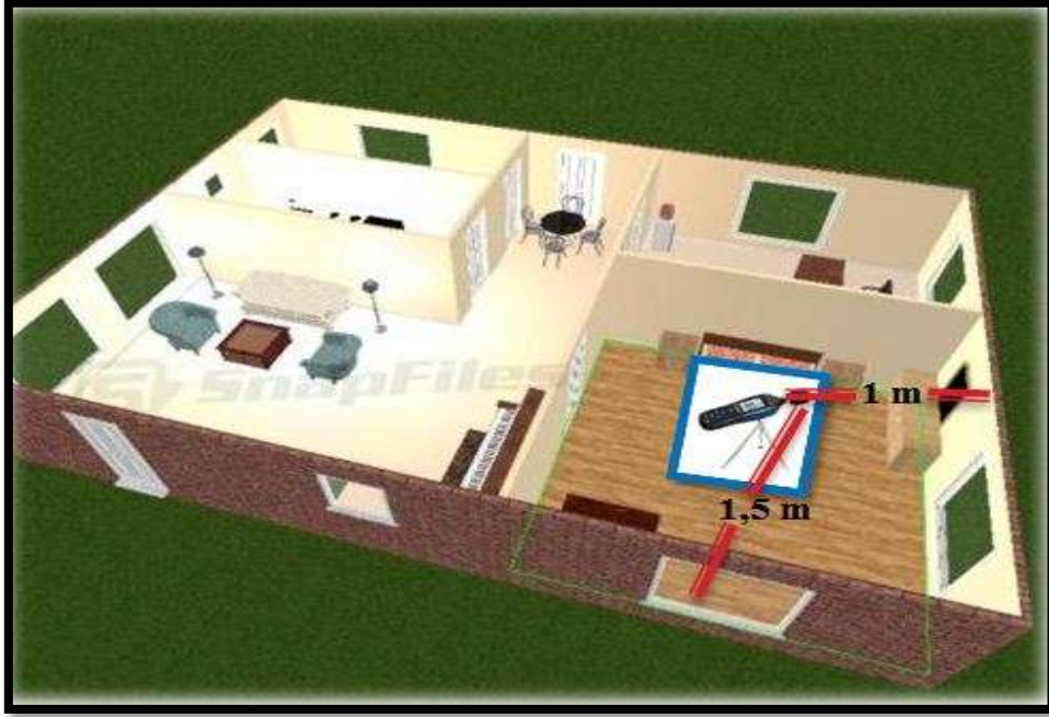
Resim 4.3: İç mekânda mikrofon konumu
