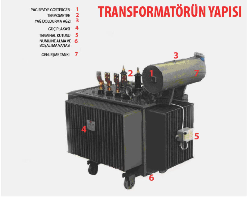
Şekil 9. Transformatörün yapısı
