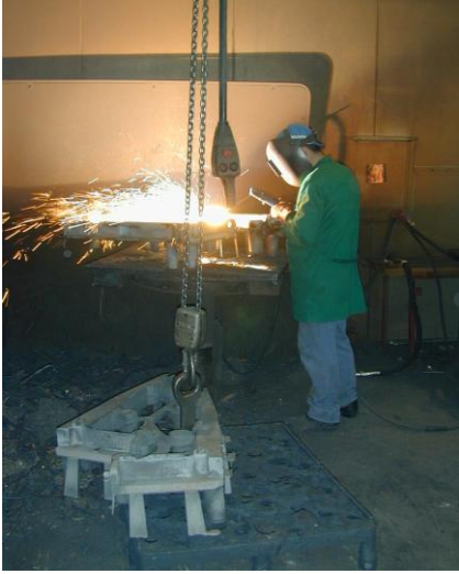
Resim 3.5: Döküm sonrası temizlik
