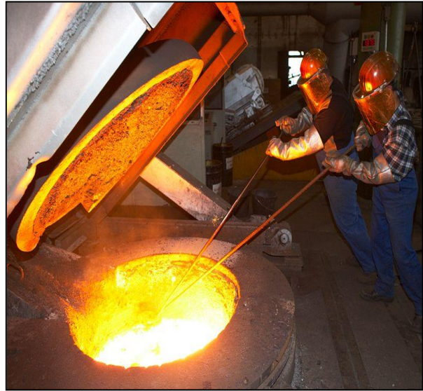
Resim 3.2 Elektrikli ocakta ergitme
