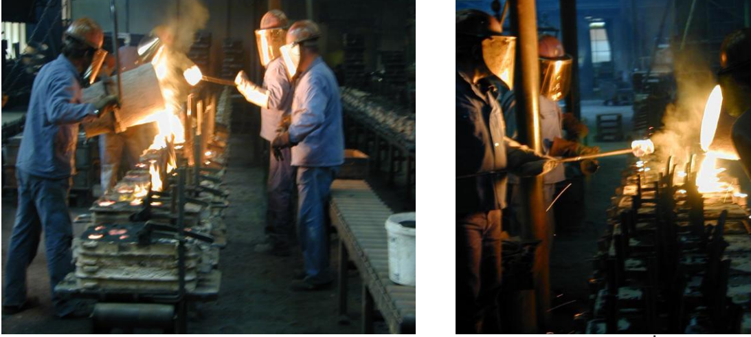
Resim 3.3 + 3.4: Döküm, Kaynak: Oederlin Döküm AG, Rieden b. Nussbaumen, İsviçre
