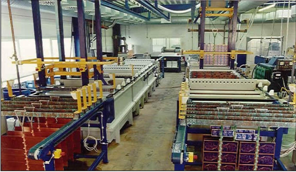
Resim 2.1: Galvanizasyon Kaynak: Leiterplattencentrum Ralf Smyczek, Almanya
