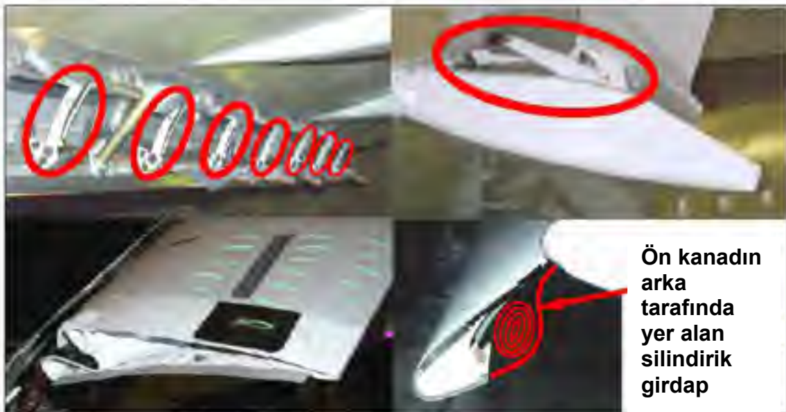
Resim 5-9: Taşıyıcı kanattaki aerodinamik gürültü kaynakları [6]
