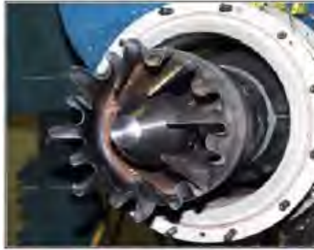
Şekil 5-23: Bir jet motoruna sonradan takılan bir karıştırıcı [3]
