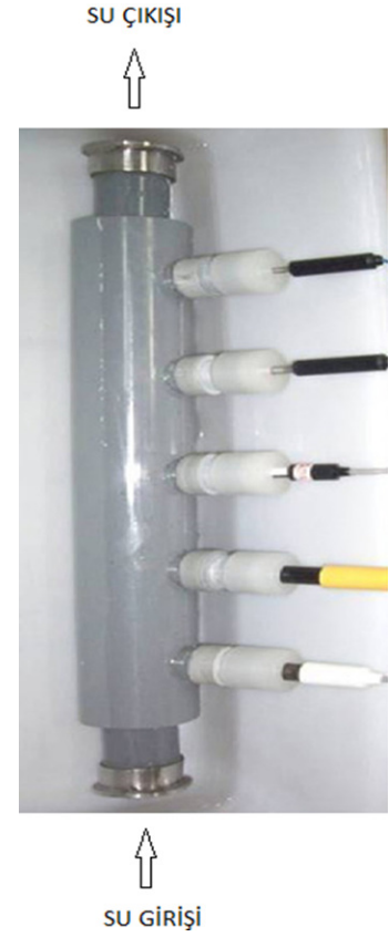
Paslanmaz çelik malzemedan üretilmiş sensör sistemi
